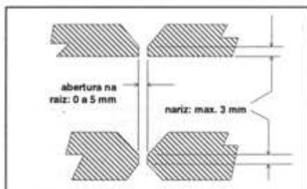
Figura 1 – Tolerâncias dimensionais
