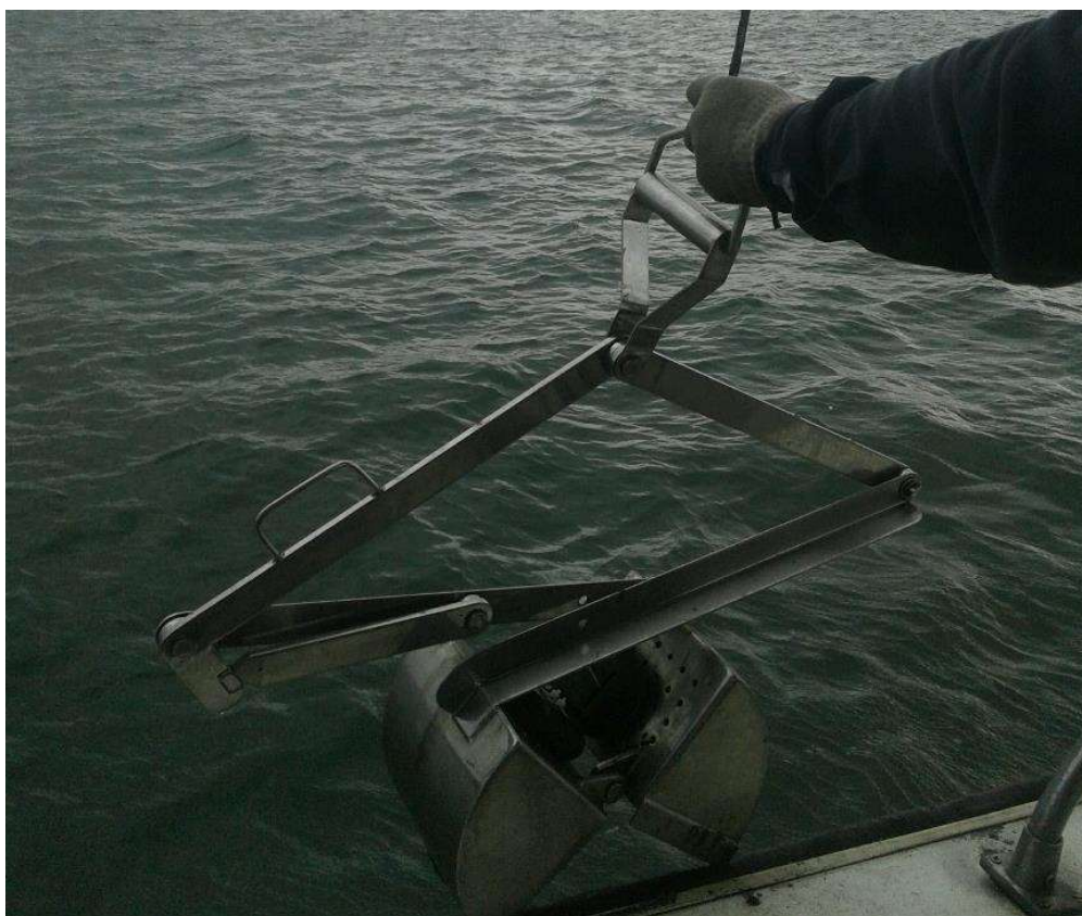
Figura 3. Amostrador Van Veen utilizada para coleta de sedimentos superficiais.
