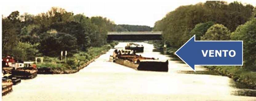
*Ilustração 05 – Embarcação descarregada sob a ação do vento*
