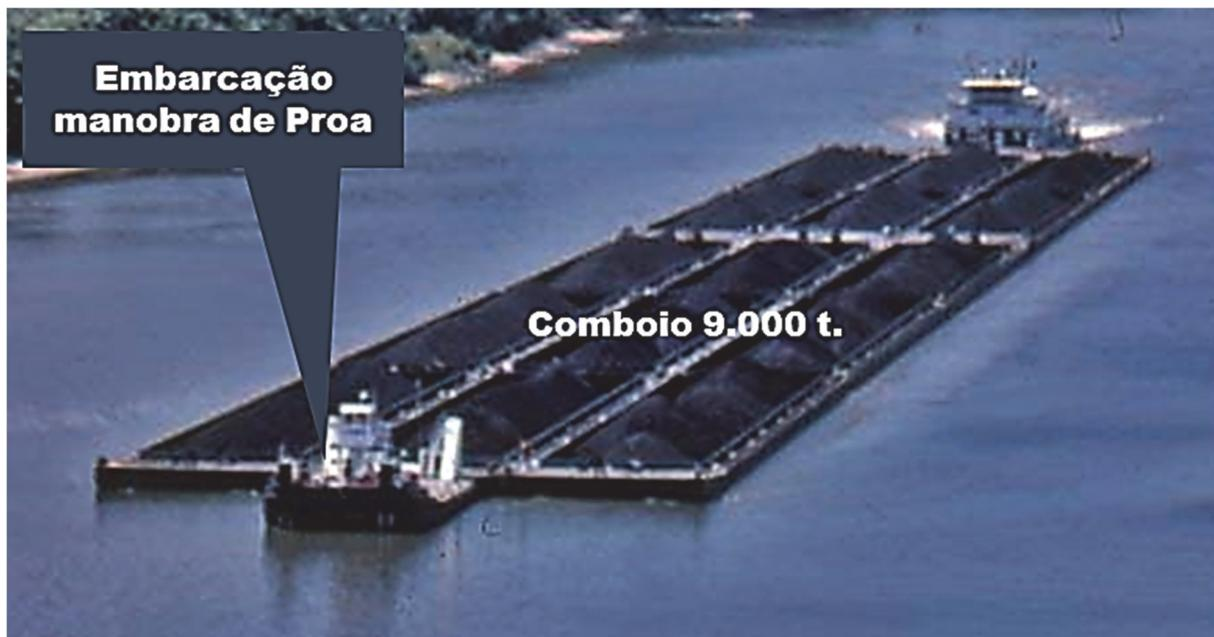
*Ilustração 17 – Comboio Americano de 9.000 toneladas de carga com bowboat para manobra.*
