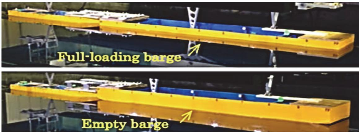
*Ilustração 11 – Testes de Comboio Lastro e Carregado*
