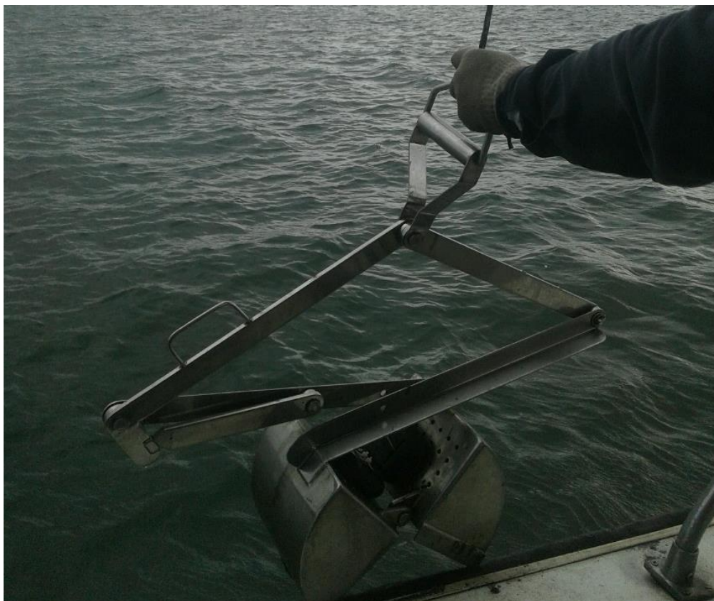
Figura 23. Amostrador Van Veen utilizada para coleta de sedimentos superficiais.
