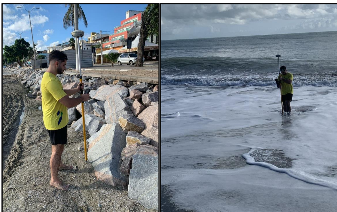
Figura 30:Exemplo de aquisição de perfil de praia com sistema GNSS - RTK.
